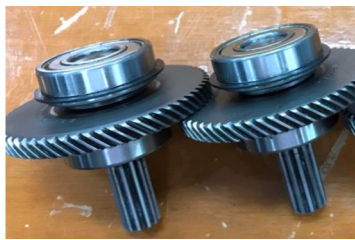
그림: 수리된 고속 기어 박스 내에 들어가는 기어부
